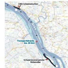
Die Unterwasserablagerungsfläche (UWA) Scheelenkuhlen gehört zu den kleineren Strombauwerken im Projekt Fahrinnenanpassung. Sie nimmt das Baggergut aus der aquatischen Kompensationsmaßnahme Schwarztonnensander Nebelbe auf.
